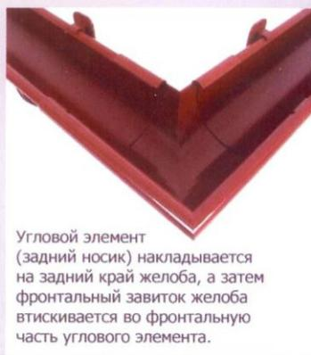
Угловой элемент (задний носик) накладывается на задний край желоба, а затем фронтальный завиток желоба втискивается во фронтальную часть углового элемента.
