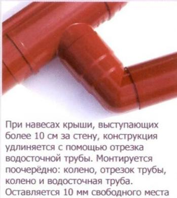
При навесах крыши, выступающих более 10 см за стену, конструкция удлиняется с помощью отрезка водосточной трубы. Монтируется поочерёдно: колено, отрезок трубы, колено и водосточная труба. Оставляется 10 мм свободного места
